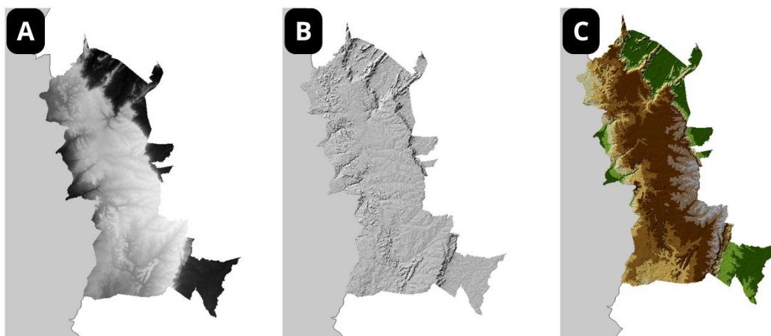
Figura 2 – Sequência de produtos da análise geomorfométrica representando o Planalto da Ibiapaba - Ce: A) Modelo Digital de Elevação (MDE), B) Sombreamento ( Hilshade ) e C) Mapa Hipsométrico.
