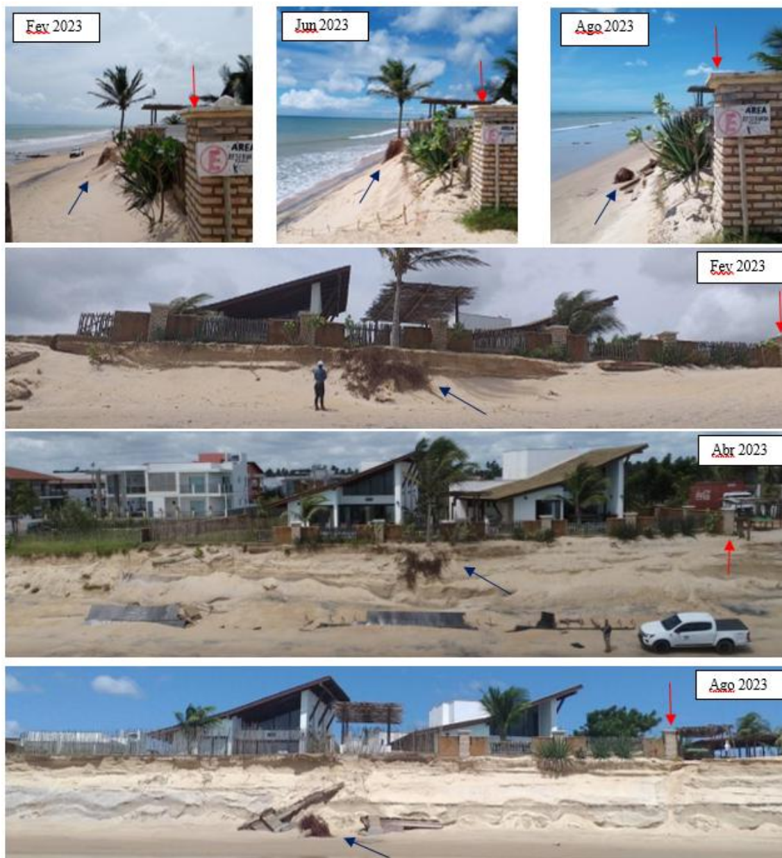
Figura 2 – Observação dos marcadores utilizados para avaliar a alteração do perfil de praia ao longo do tempo através de imagens. As setas vermelhas representam o marcador fixo (muro) utilizado como referência na Figura 1 e as setas azuis indicam os indícios da perda de material sedimentar junto à árvore.
